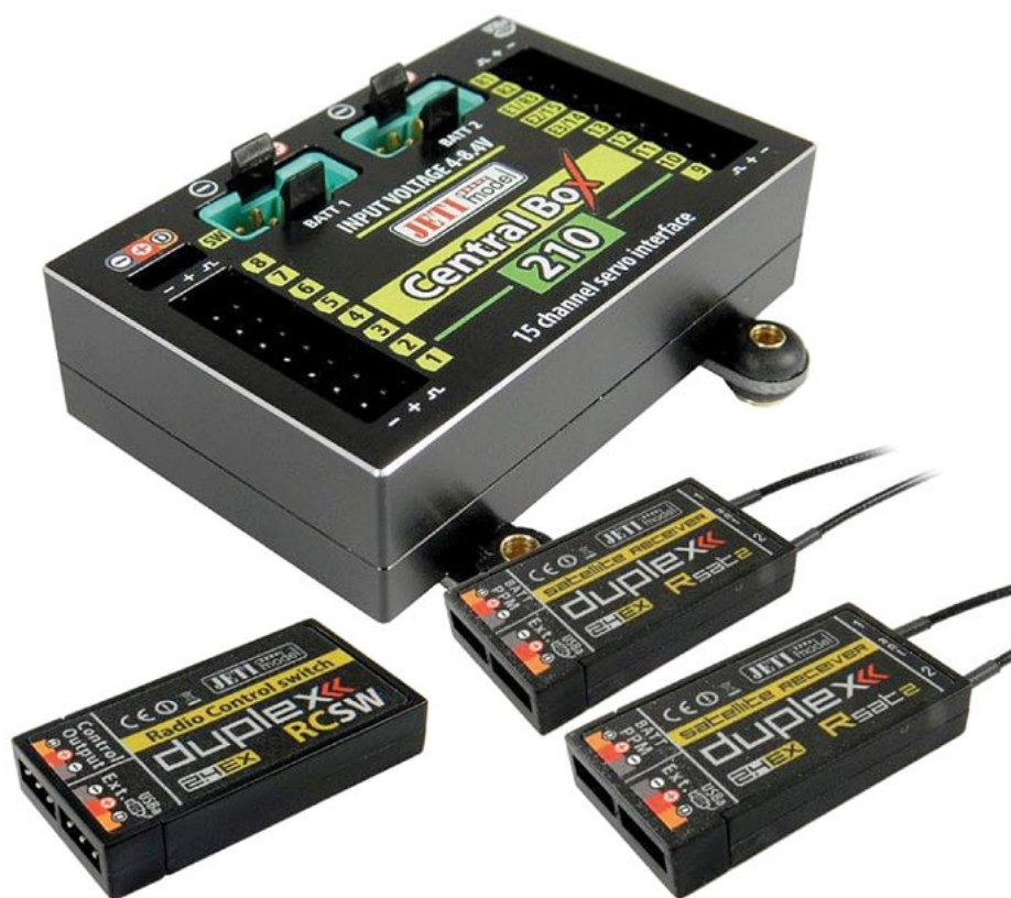
Central Box można kupić oddzielnie lub w komplecie z przydatnymi akcesoriami. Na zdjęciu: Central Box 210 w komplecie, tj. z przełącznikiem RCSW oraz dwoma odbiornikami Rsat, wykluczającymi konieczność użycia innych odbiorników w modelu. Podobnie jak w przypadku starej centrali 200, a także większej 400, również tu do podpięcia akumulatorów zasilających użyto bardzo stabilnych konektorów typu MPX.
