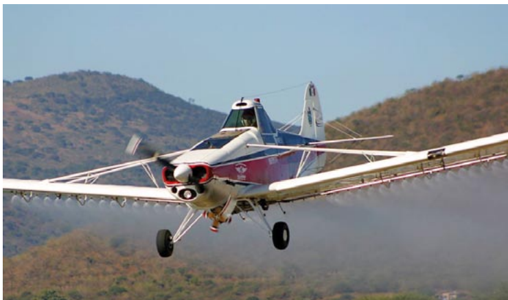
Piper PA-25 Pawnee podczas wykonywania prac agro. Dobrze widoczny, umiejscowiony przed kabiną, zbiornik na chemikalia. Fot. Internet
